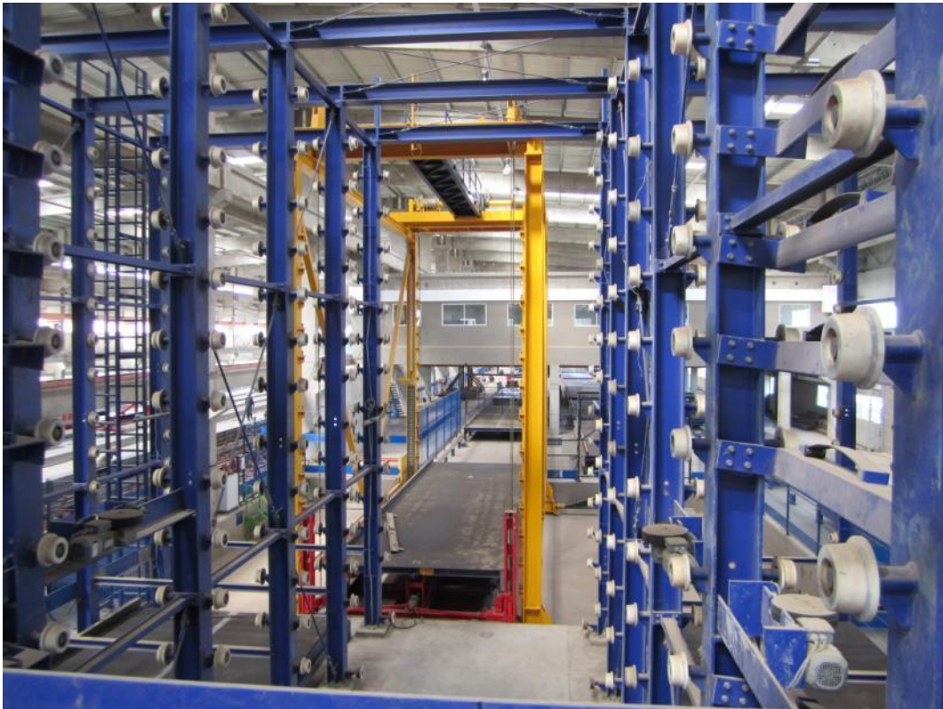
Fig. 13: 托盘在摩擦轮和推拉装置的作用下进出固化室
