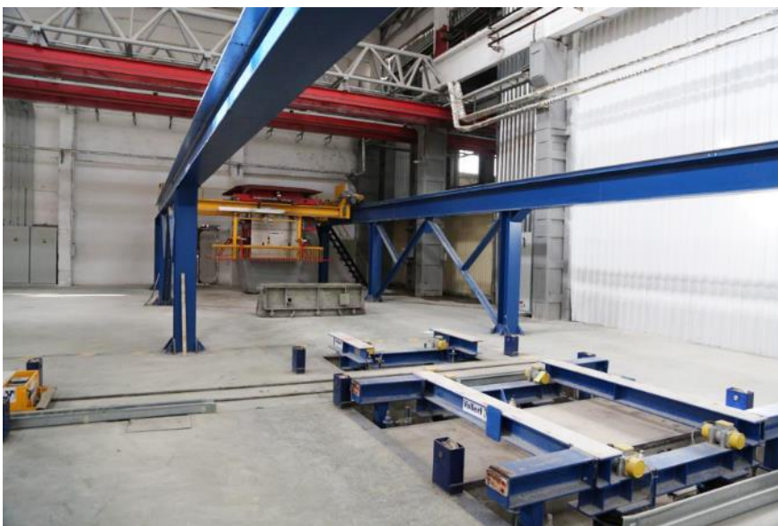
Fig. 5: Vario COMPACT震动工作站为实体混凝土控件打造完美的表面，质量能够达到露石混凝土级别
