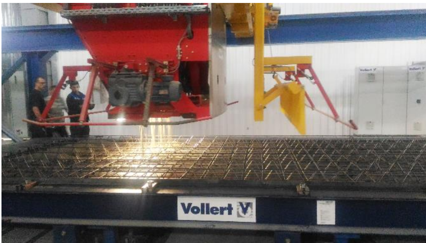
Fig. 4: 混凝土分配机的尖头滚筒的容量和速度可根据不同的混凝土材质进行优化调节
