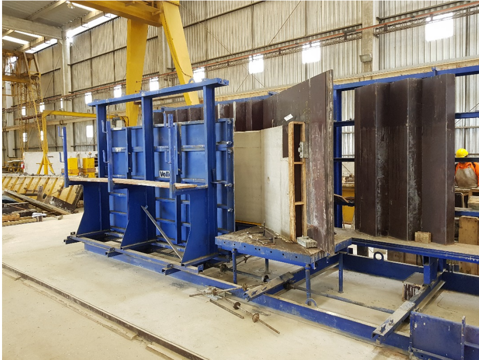
图1 MARNA Pré-fabricados 公司 ( 位于巴西皮涅斯 ) 的新型VARIOSTEP 楼梯模具170-17。
