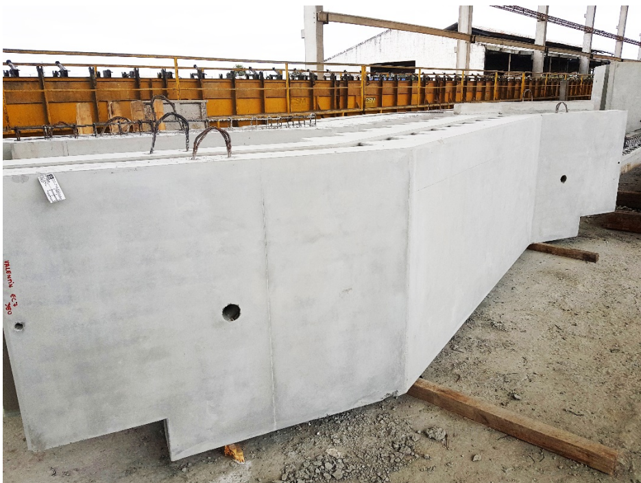
图2 混凝土三面平滑，这是预制混凝土楼梯高质量的重要特征。
