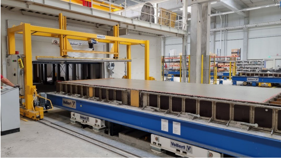
图6: 智能紧凑型振荡站确保了混凝土浇筑过程之后的紧实度。
