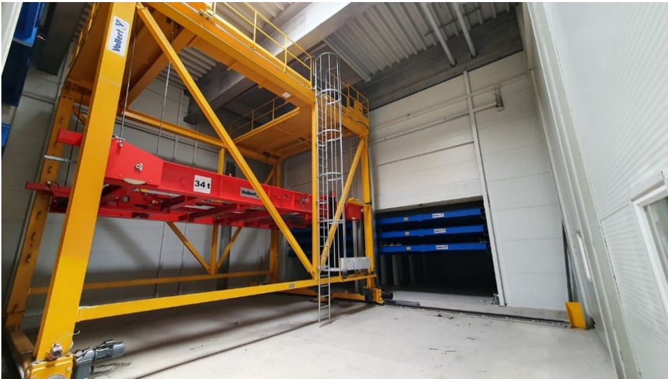
图7: 完全隔热和加热后的Vario CURE养护窑成为新墙板生产线的核心。
