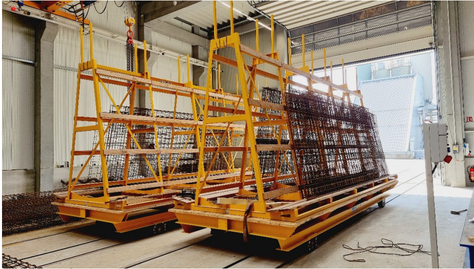
图10: 运输小车运送钢筋网。
