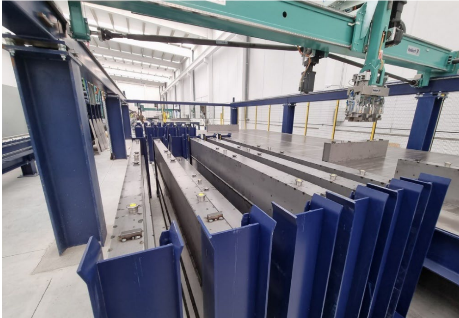
图 3: 横向和纵向模板型材在 SMART SET 机器人生产线上通过 CAD/CAM 控制按照所谓的风车原理定位。
