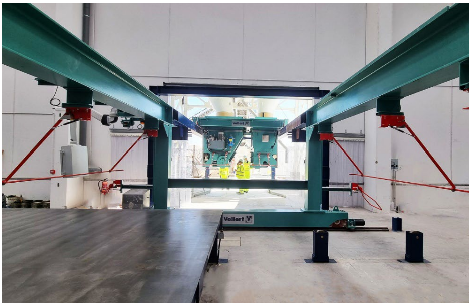
图 4: 由于自密实特殊轻质混凝土具有一定的稠度，需要 SMART CAST 混凝土分配机与推出装置配合使用。此外，双铲斗设计可以根据需要进行混凝土卸料。
