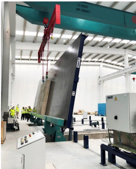
图 6: 使用升降横梁从倾卸站取下墙壁，并放置在装载框架上。
