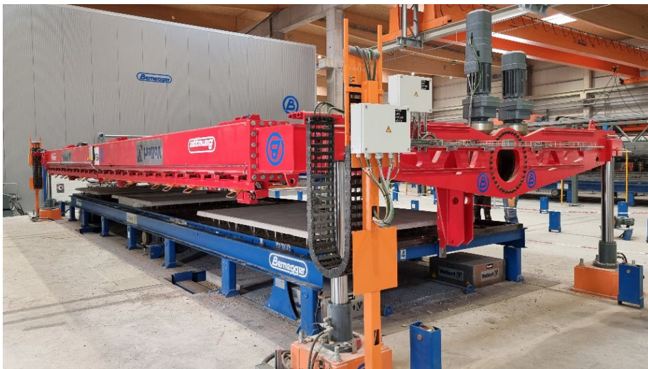
图 6 : 在双层墙生产中，固定的 Vario TURN 托盘翻转机确保了简单的半自动翻转过程。
