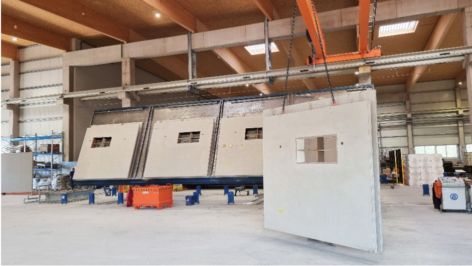
图 9 : 双层墙的垂直提升由 Vario TILT 倾斜站进行。
