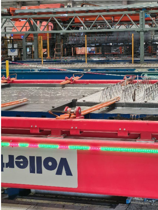
图 7： LED 指示灯位于翻转机的纵向侧，显示在哪些调整位置不能插入夹持臂。
