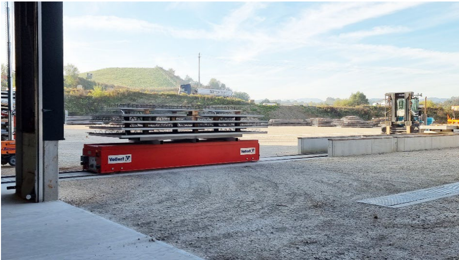
图 10 : 从元件板材堆垛到外部区域的运输，通过移动小车进行。
