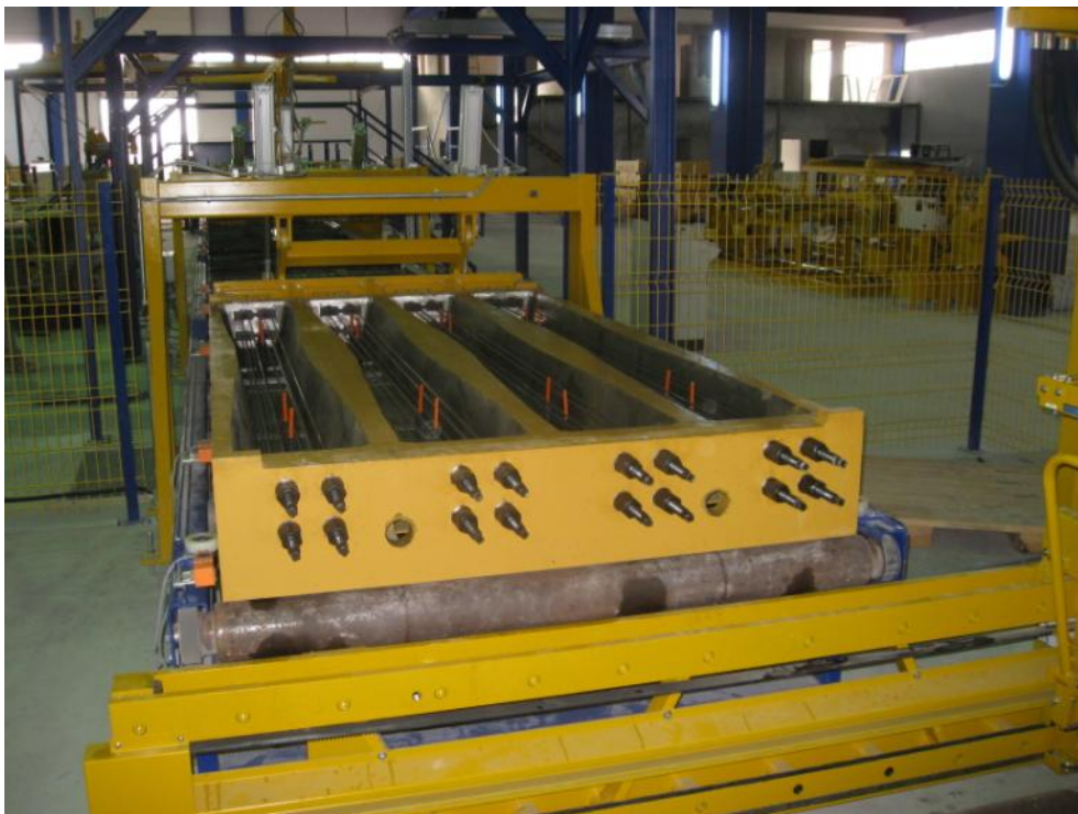
Fig 2: 加固后的轨枕模具
