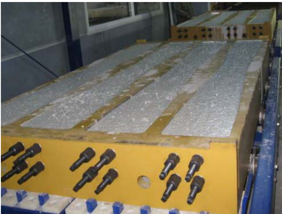
Fig 4: 混凝土浇筑后的轨枕模具
