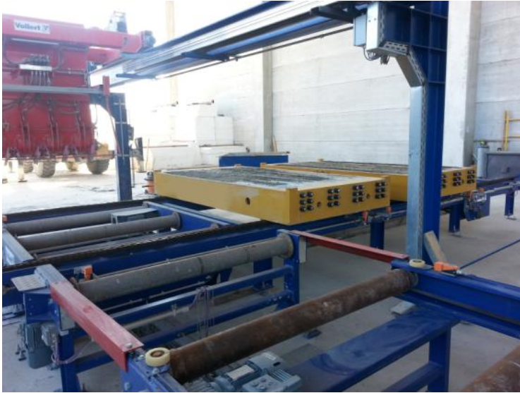
Fig. 4: 半自动的混凝土布料机借助电动卸料螺杆精准地对模具布料
