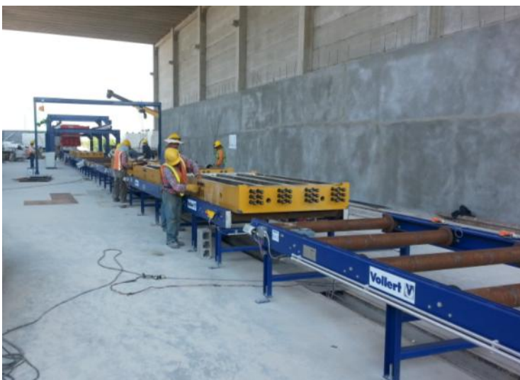
Fig. 3: 预先装好的模具会通过辊式输送机传送到隔音的浇注室中
