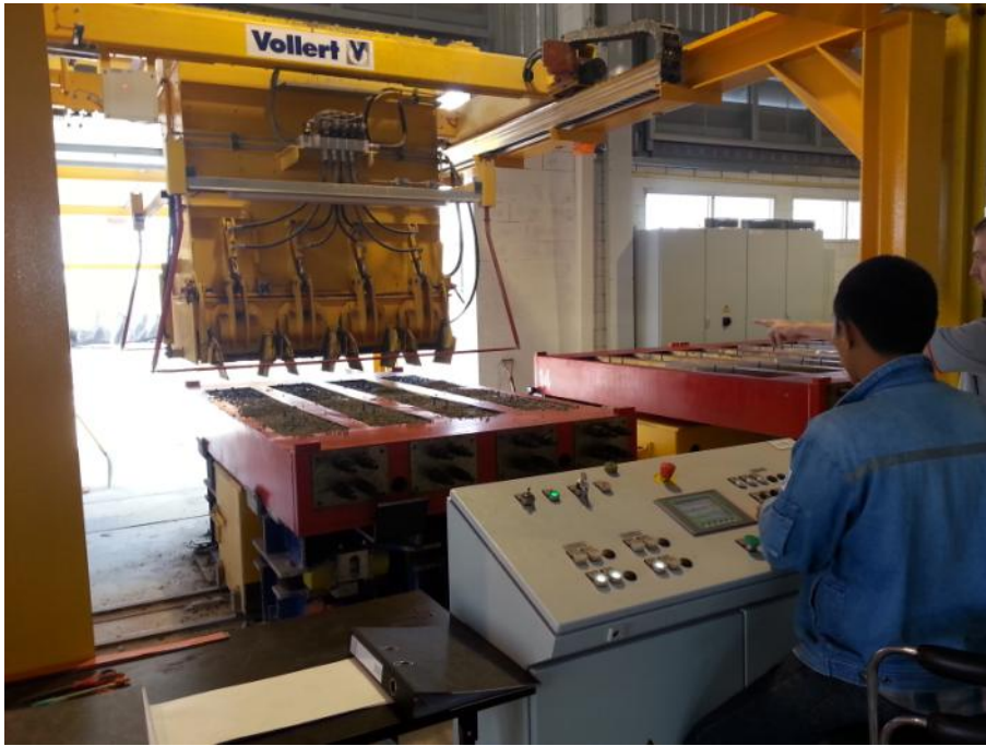
Fig. 5: 在室外区域和混凝土浇筑线中，半自动混凝土分配器可在混凝土搅拌站之间沿着桥梁结构移动
