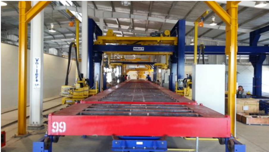
Fig. 9: 然后借助半自动去张力站点启动预应力释放过程
