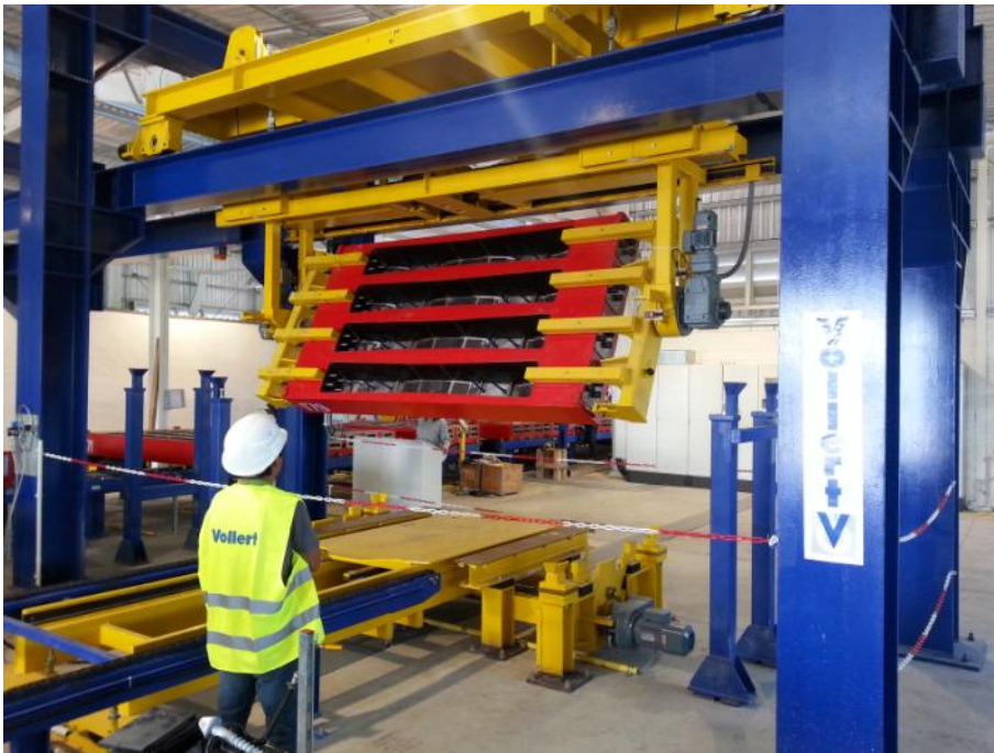
Fig. 10: 在脱模程序执行之前，利用电动升降设备，桥梁引导型翻转吊梁可将松弛混的凝土模具放至出口区域，并旋转180度
